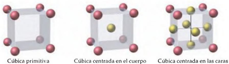
▲ Figura 11.33 Los tres tipos de celdas unitarias que se encuentran en redes cúbicas. Por razones de claridad, las esferas de las esquinas son rojas y las centradas en el cuerpo y las centradas en las caras son amarillas. Cada esfera representa un punto de red (un entorno idéntico en el sólido).
